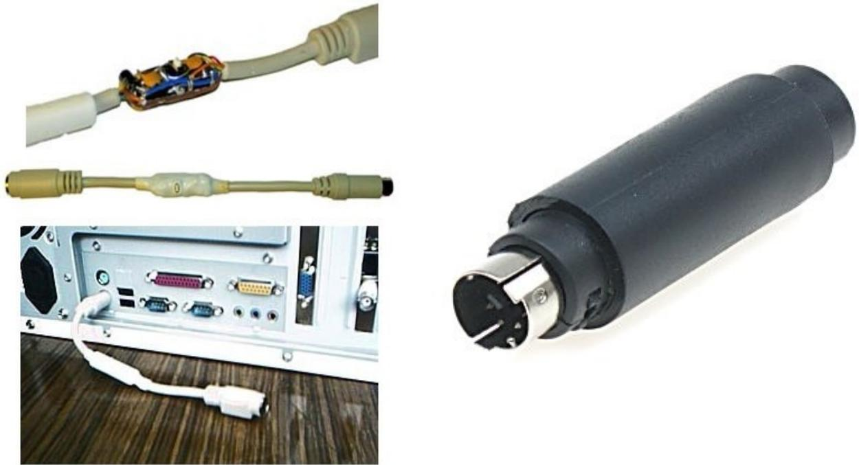
Esses keyloggers físicos se parecem com adaptadores de teclados PS2/USB, sendo instalados entre o cabo do teclado e a entrada PS2 da CPU, só que eles armazenam dentro de uma memória flash tudo o que é digitado no teclado “grampeado”.
